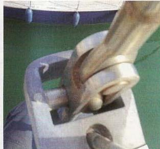
Verifica dello stato delle crocette. Sotto, l'attaccatura all'albero; è importante che sia perfettamente integra. A sinistra, controllo della posizione delle sartie
